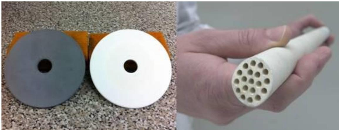
**Abbildung 2: Die untersuchten Membranen. Links Membranscheibe SiC, in der Mitte Membranscheibe TiO<sub>2</sub>/Al<sub>2</sub>O<sub>3</sub> und rechts die Rohrmembran ZrO<sub>2</sub>-TiO<sub>2</sub>/TiO<sub>2</sub>-Al<sub>2</sub>O<sub>3</sub>.**
